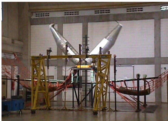
Figura 19 - Teste de separação da coifa principal.
