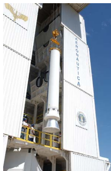
Figura 23 - Içamento para integração do segundo estágio.
