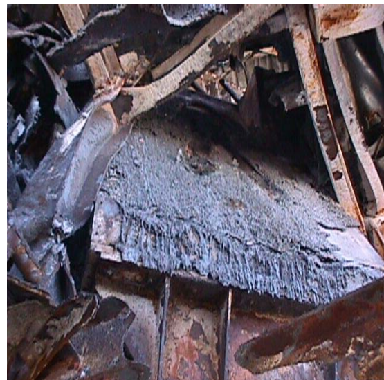
Figura 49 - Defletor que ficava posicionado sob o propulsor A.
