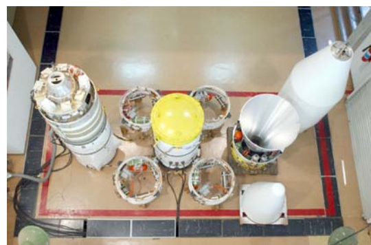
Figura 17 - Teste das redes elétricas integradas.
