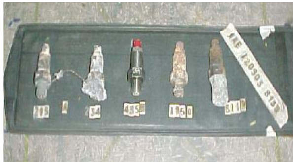
Figura 67 - Conjuntos de iniciação recuperados. Da esquerda para a direita: par de conjuntos pertencentes ao propulsor A, conjunto do estoque, conjunto do propulsor B e conjunto reserva, queimado no incêndio.
