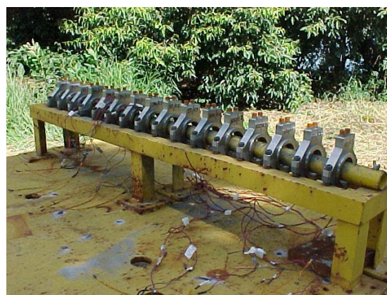
Figura 18 - Teste de pirotécnicos do sistema de separação do primeiro estágio.
