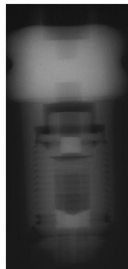
Figura 76 - Radiografia de um conjunto de iniciação original (não acionado).
