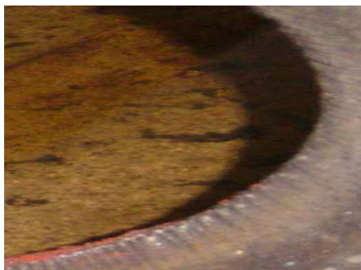
Figura 56 - Detalhe do inserto carbono-carbono da garganta do propulsor A do primeiro estágio. Observa-se que há “estrias” (ou desgaste) aparentes, o que indica que fluxo de gases passou por essa região.
