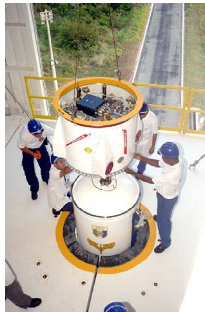
Figura 27 - Baía de controle sendo integrada ao Veículo, na torre móvel de integração.
