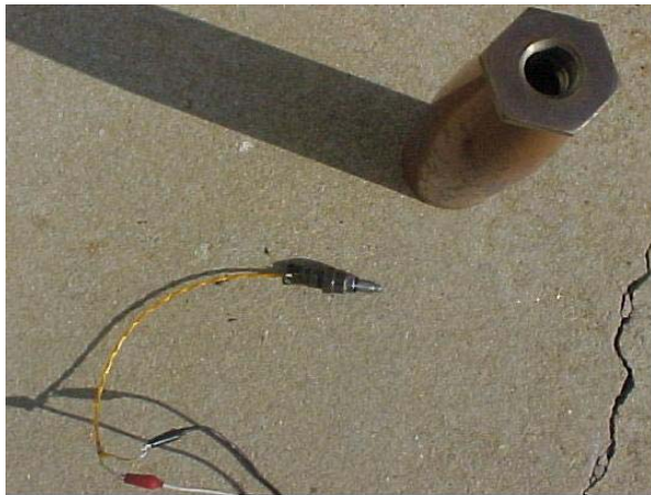
Figura 84 - Componente pirotécnico íntegro após 02 horas e 03 minutos de ensaio com baixa corrente.
