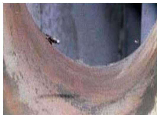
Figura 54 - Detalhe do inserto carbono-carbono da garganta do propulsor do segundo estágio.
