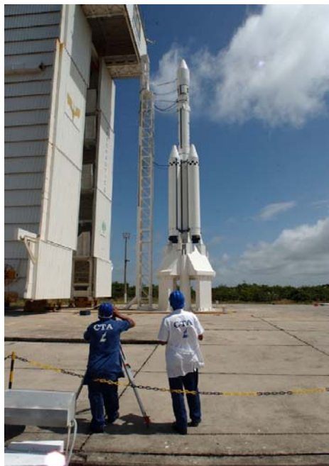
Figura 32 - Verificação da verticalidade do Veículo.
